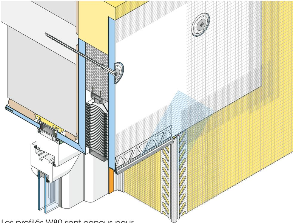
Les profilés W80 sont conçus pour une épaisseur totale de l'enduit de 7 mm. Afin que le bord avant se trouve au même niveau, les profilés de raccord latéraux, tels que des profilés d'angle ou des panneaux d'embrasure avec profilés de finition, doivent être appliqués conformément au bord avant W80 de manière à ce qu'ils affleurent l'enduit.
