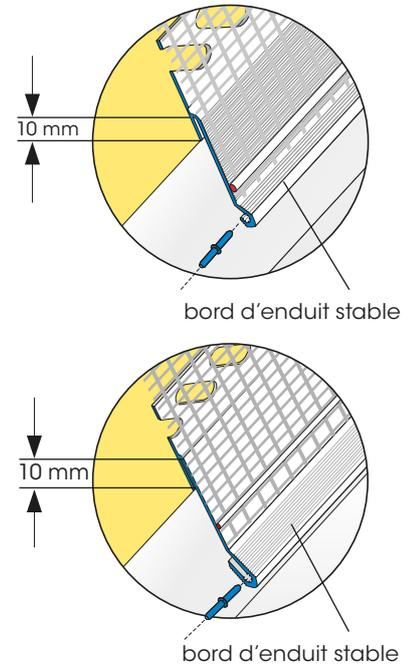
■ Ce profilé est emboîté sur des raccords en tôle (p. ex. bord du toit) et réalise, par sa cavité, une jonction mobile et étanche à l'eau entre l'enduit et la tôle. Les mouvements de compensation de la tôle sont absorbés par le profilé, ce qui empêche la formation de fissures dans l'enduit. Le bord d'enduit pressé (terminé) (W45-8 pour les enduites de 8 mm d'épaisseur et W45-11 ceux de 11 mm) assure une évacuation ciblée de l'eau.
