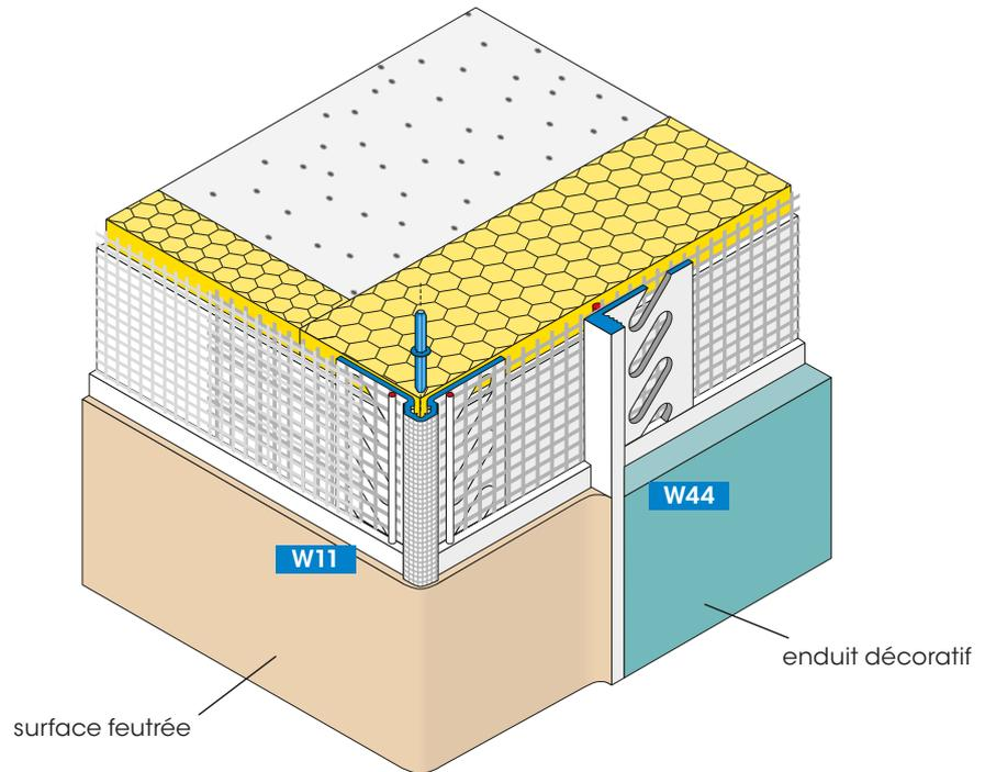
■ Le profilé de finition avec partie en fibre de verre soudée permet de réaliser les finitions d'enduit sur les systèmes composites d'isolation thermique.
