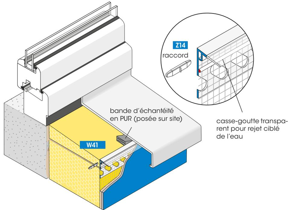
■ Le profilé de finition FEBA-TEX-ATTIKA forme une finition d'enduit précise en-dessous de l'appui de fenêtre, dans la zone de l'attique en-dessous du revêtement en tôle ou similaire.
