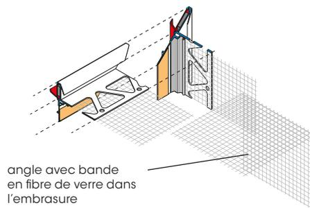
angle avec bande en fibre de verre dans l'embrasure
