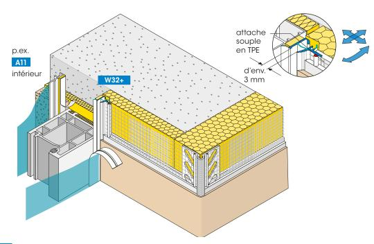
Le profilé avec bande en fibre de verre MILANO-plus est prévu pour des systèmes composites d'isolation thermique avec une isolation profonde de l'embrasure, pour des épaisseurs d'isolation jusqu'à 160 mm et pour des fenêtres montées affleurant le mur.
