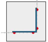
■ Profilé d'angle avec bande en fibre de verre APU ULTRA-TEX avec arêtes de raclage
