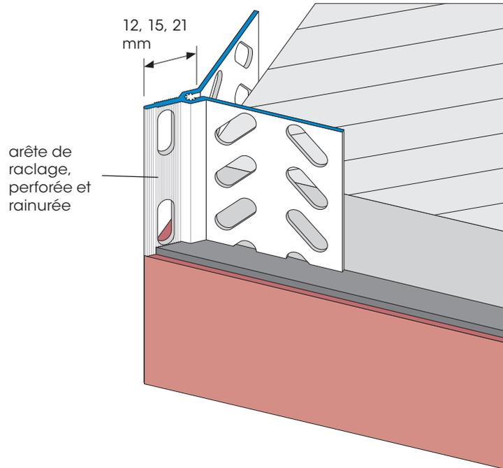
Profilé d'angle APU en matière plastique ayant des ailes avec perforation latérale et une arête perforée en saillie. Peut être utilisé à l'intérieur et à l'extérieur.
