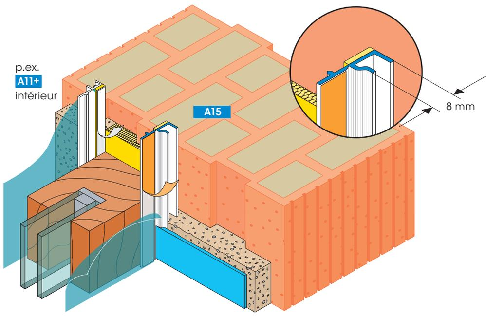
Les murs à haute isolation thermique et les enduits d'isolation exigent, à l'intérieur et à l'extérieur, des finitions d'enduit étanches et sûres aux fenêtres, portes et autres composants de construction.
