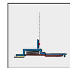
Perfil de remate con malla APU PUR-FIX-pro para todo tipo de puertas y ventanas convencionales
