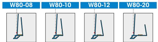
Perfil encajable para paneles de revoque
