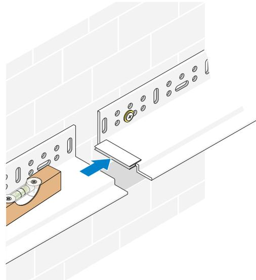
La pieza de unión a tope Z61 facilita la alineación enrasada y sin desplazamiento de rieles de zócalo/montaje con un espesor de material de hasta 2,5 mm. Para ello se cortan si es necesario partes de las barras con ayuda de las tenazas de corte Z12.
