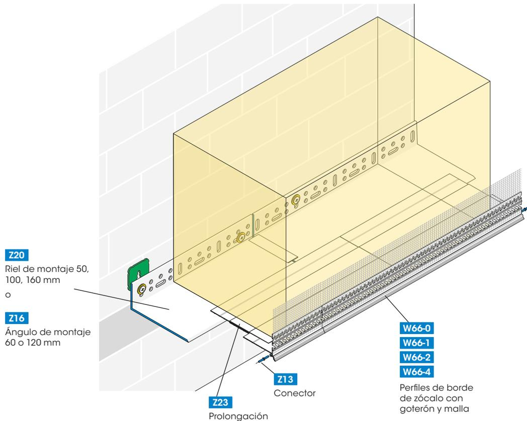
La prolongación de plástico APU Z23 amplía entre 30 y 50 mm el desarrollo de los perfiles de borde de zócalo APU W66. En combinación con el perfil de borde de zócalo W66, dos prolongaciones Z23 y el riel de zócalo Z20-160 son posibles espesores de aislamiento de hasta 300 mm.
