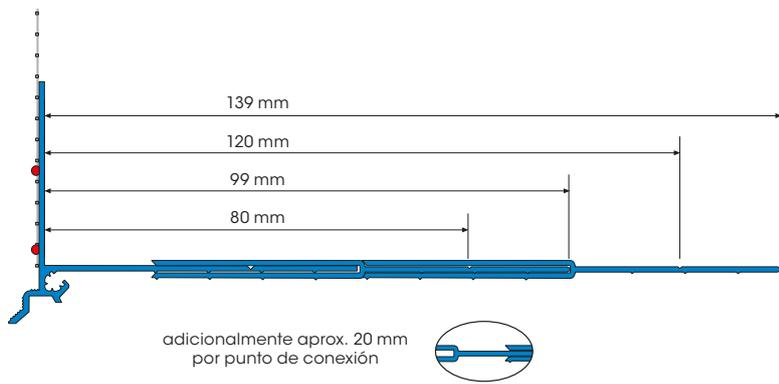
Ejemplo para espesor de aislamiento de 300 mm
