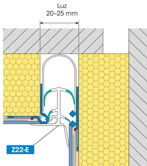
Si se deben cubrir los perfiles para juntas de dilatación abiertos W51, W52 por motivos ópticos, es posible utilizar para este fin el perfil de recubrimiento Z22-E para esquinas o el Z22-F para la superficie.
