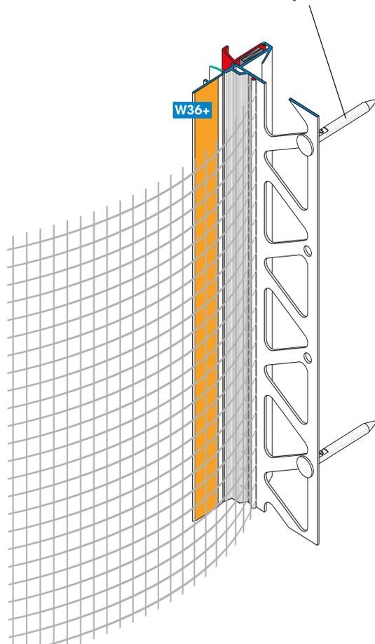
\*) no utilizar clavos de plástico en paneles aislantes de vacío. En su lugar emplear para la fijación almohadillas adhesivas de hotmelt o similares.
