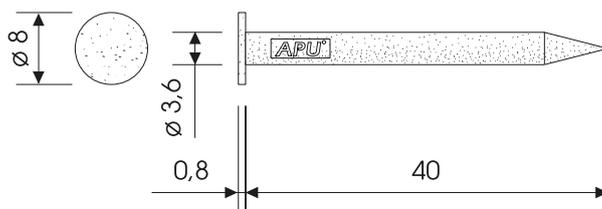
El clavo de plástico APU Z21 facilita la colocación de perfiles de SATE.
