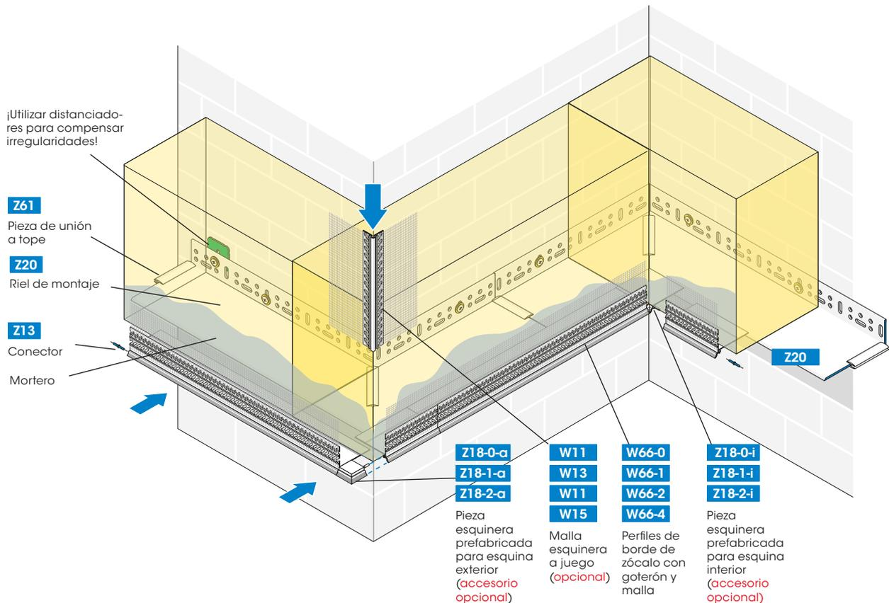
El riel de montaje APU Z20, disponible en 3 desarrollos diferentes, forma junto con los perfiles de borde de zócalo APU W66 una superficie cerrada para el cierre del aislamiento del SATE para espesores de aislamiento de entre 50 y 300 mm (a partir de 160 mm se requiere un aislamiento perimetral).
