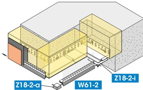
Con las uniones esquineras Z18 para esquinas interiores y exteriores se pueden preparar esquinas limpias y exactas con gran facilidad y rapidez. Los pasadores existentes a derecha e izquierda en la unión esquinera se encajan en los perfiles adyacentes W40, W61 o W66. A continuación, cerrar todos los bordes de perfil enrasados entre sí.
