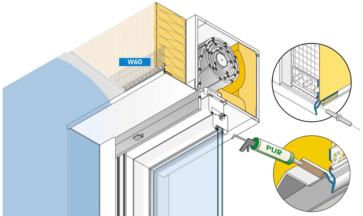
Este perfil es apto para conexiones de revoque en cajas de persiana. El perfil se pega sobre el borde metálico sobresaliente de la caja y a las juntas con conectores APU. Además, el perfil de conexión APU W60 puede utilizarse en transiciones de chapa para componentes de construcción escalonados (p. ej. transición de la pared de la casa al garaje).
