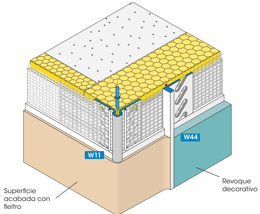
■ El perfil de remate con pieza de malla soldada forma conexiones de revoque de enlucido fino en sistemas compuestos de aislamiento térmico.
