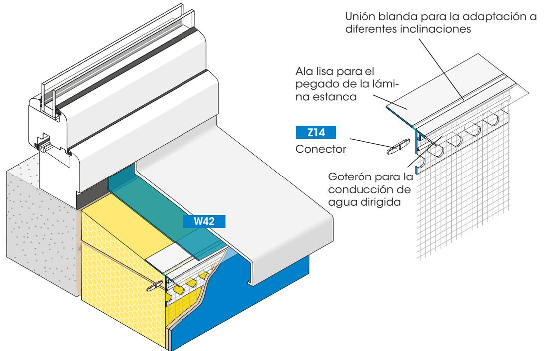
El perfil de conexión FEBA-TEX-UNI forma un acabado del revoque limpio en el alféizar en caso de ejecución de un segundo nivel de sellado.
