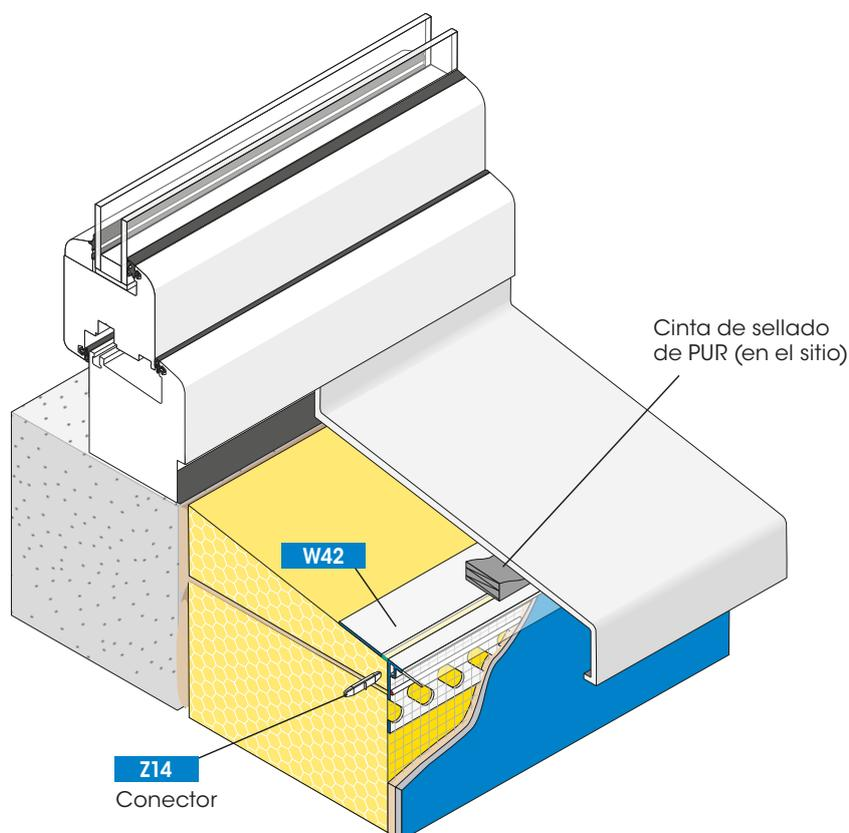
El perfil de conexión FEBA-TEX-UNI forma también un acabado del revoco limpio en el alféizar en caso de ejecución de una conexión sin un segundo nivel de sellado.
