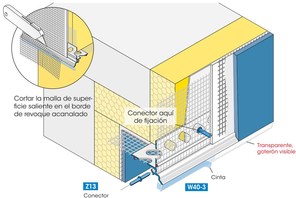
Las conexiones de revoque en sistemas compuestos de aislamiento térmico requieren también una solución segura con respecto a la conducción y desviación de agua hacia abajo.
