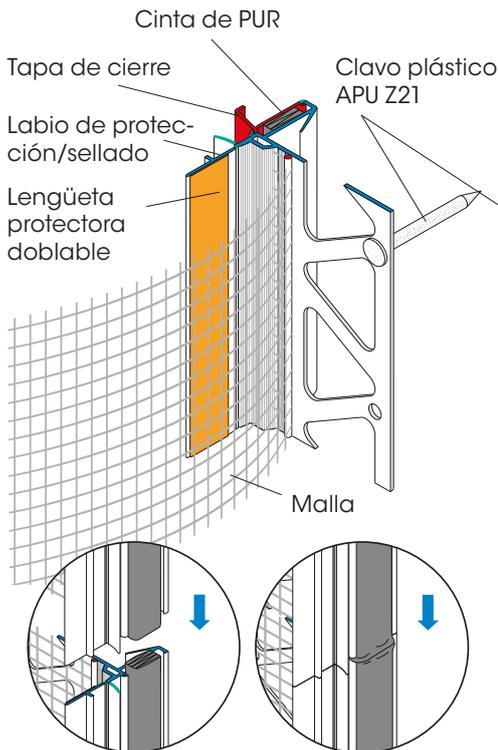
La cinta de PUR que sobresale sirve de material de sellado entre dos perfiles
