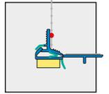
Perfiles para sistemas compuestos de aislamiento térmico
