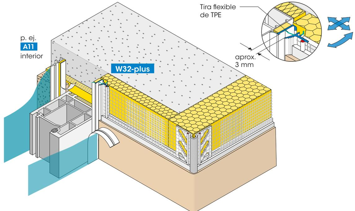
El perfil de remate con malla MILANO-plus está concebido para sistemas de SATE con aislamiento profundo de intradós, espesores de aislamiento de hasta 160 mm y ventanas enrasadas con la mampostería.
