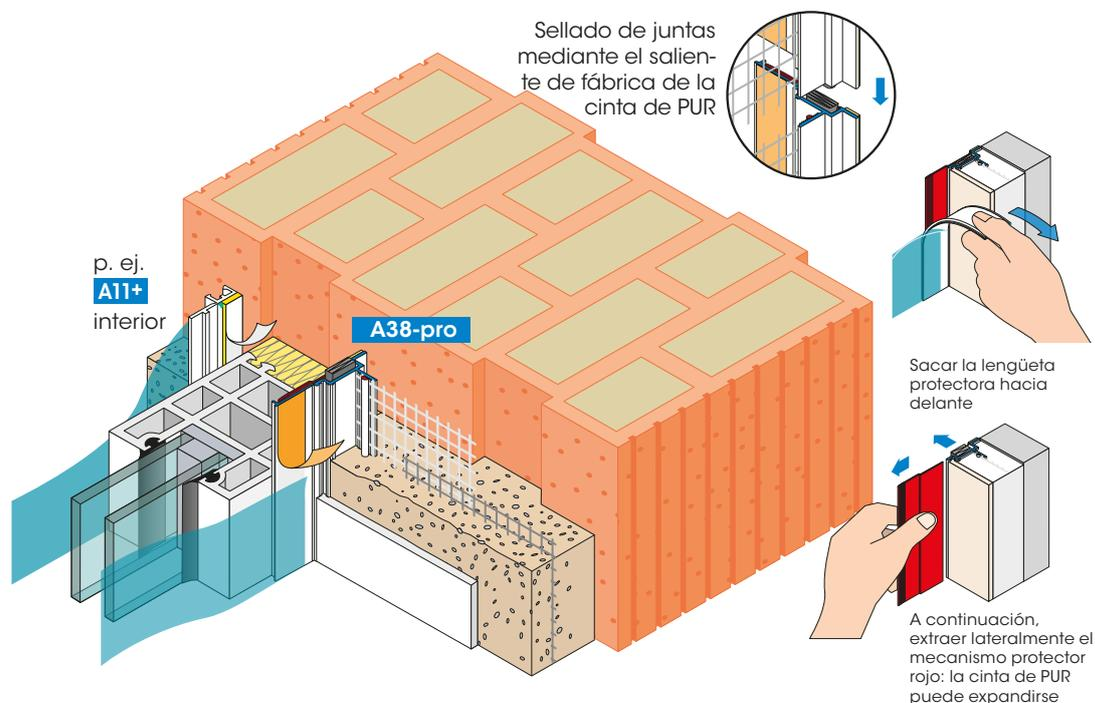
El perfil de remate de revoque telescópico PUR-FIX-pro está concebido para conexiones de revoque en las que se debe contar con mayores movimientos y para las que no se desea un pegado al componente.
