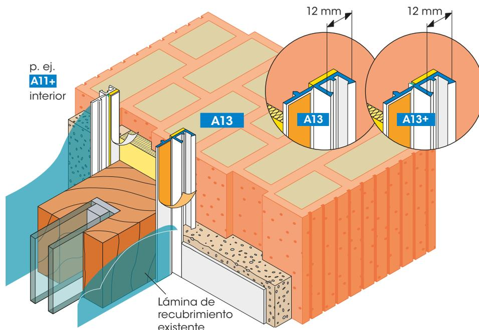
La mampostería de alto aislamiento térmico y los revocos de fondo/esgrafiados requieren conexiones de revoque interiores y exteriores estancas y seguras en puertas, ventanas y otros componentes.
