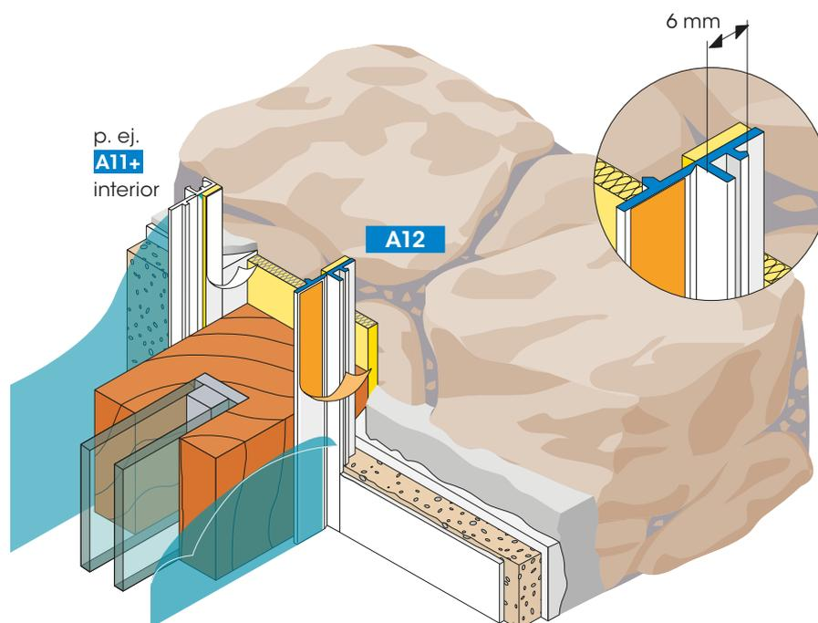
Es posible renovar los revocos antiguos y eliminar sus grietas con masillas de alta calidad y refuerzos de malla. Para la conexión a prueba de lluvia entre la masilla y el componente, este perfil de remate de revoque **con dos nervios** forma una junta de dilatación segura y duradera. El perfil de remate está provisto de una cinta de sellado de PE autoadhesiva y crea una unión estanca con el marco mediante presión.
