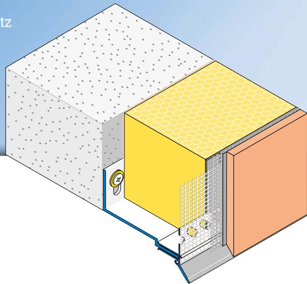
Die **APU-Sockelschiene SOLI-TEX-QUATTRO** wird in Wärmedämm-Verbundsystemen als unterer Abschluss der Wanddämmung eingesetzt. Die Sockelschiene gibt es in verschiedenen Ausladungen (50, 60, 80, 100, 120, 140 und 160 mm Dämmstoffstärke). Bei grösseren Dämmstoffstärken kann die Sockelschiene mit der Verlängerungsschiene SOLI-TEX (Z63) um jeweils 40 mm auf bis zu 240 mm erweitert werden. Das Aufsteckprofil QUATTRO bildet eine exakte Putzkante für Kratzputz.
