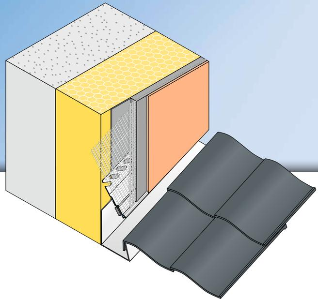
Das **APU-Blechanschlussprofil PUR-FIX** wird in Wärmedämm-Verbundsystemen auf Blechanschlüssen (z. B. Dachrandanschluss) eingesetzt und ergibt durch sein integriertes PUR-Dichtband eine bewegliche Verbindung zwischen Putz und Blech. Das Profil sorgt nach Abschluss der Putzarbeiten für eine gezielte Wasserführung.
