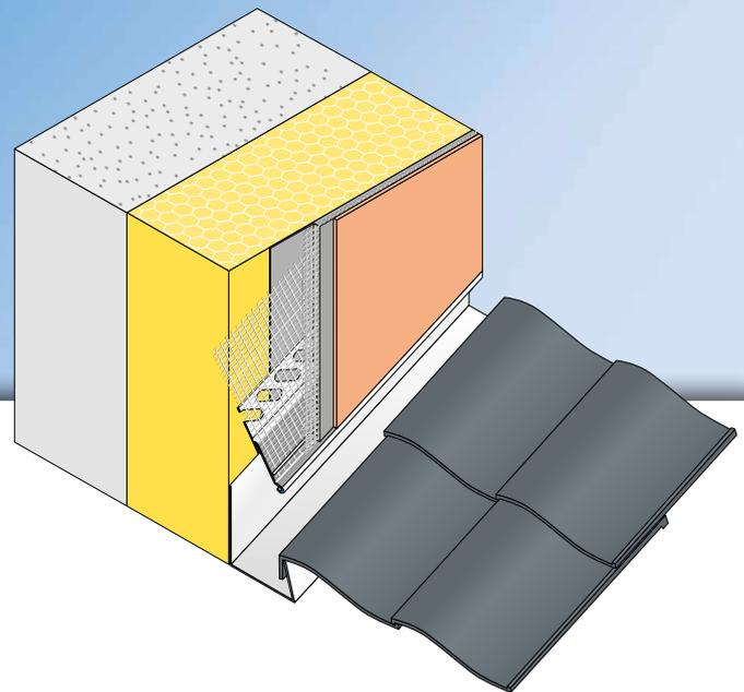
Das **APU-Blechanschlussprofil FIN-TEX** wird in Wärmedämm-Verbundsystemen auf Blechanschlüsse (z. B. Dachrandanschluss) eingesetzt und ergibt durch seine Hohlkammer eine bewegliche Verbindung zwischen Putz und Blech. Das Profil wird für 11 mm Putzstärke eingesetzt und sorgt nach Abschluss der Putzarbeiten für eine gezielte Wasserführung.
