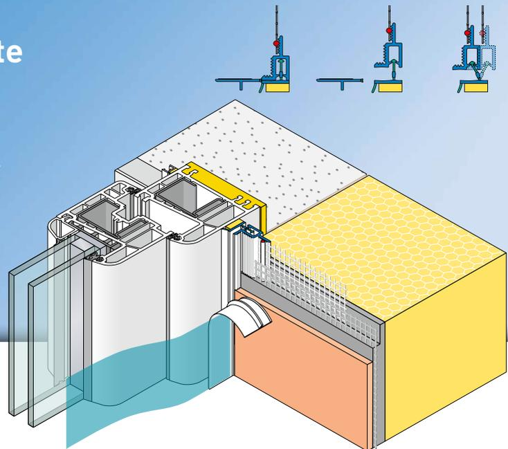
Die **APU-Teleskop-Gewebeleiste IDEAL-plus** wird in Wärmedämm-Verbundsystemen gemäss den aktuellen APU-Auswahlkriterien eingesetzt. Das Profil wird vor die Laibungsdämmung fluchtgerecht auf das vorhandene Bauteil geklebt und bietet nach Abschluss der Putzarbeiten einen sauberen und sicheren Putzanschluss.
