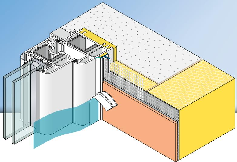
Die **APU-Gewebeleiste MINI-plus** wird in Wärmedämm-Verbundsystemen gemäss APU-Anwendungsbereich eingesetzt.
