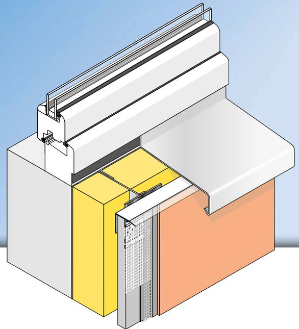
Das **APU-Aufsteckprofil VHF-TOP-TEX** wird bei vorgehängten, hinterlüfteten Fassaden auf die Oberkante der Trägerplatte im Bereich der Attika oder unter der Fensterbank eingesetzt.
