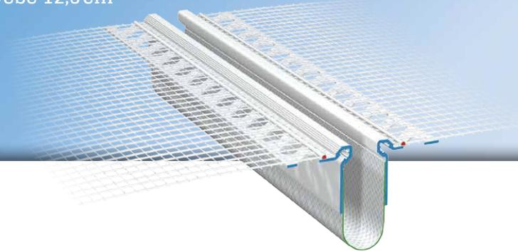
Das **APU-Dehnfugenprofil DUO-TEX** wird in Wärmedämm-Verbundsystemen bei vertikalen Gebäudefugen eingesetzt. Für die fluchtgerechte Ausbildung einer sauberen Putzkannte werden die Profile für die Fläche (W52) und für die Innenecke (W51) hergestellt.
