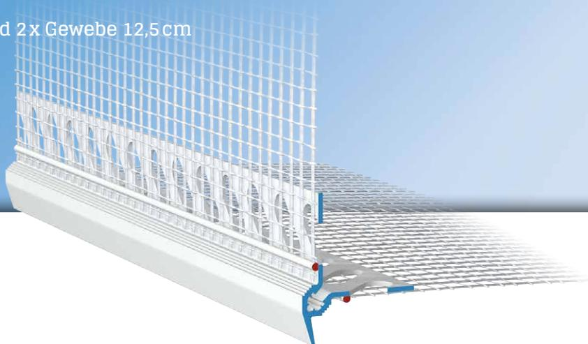
Das **APU-Abschlussprofil DROP-TEX-ZERO** wird in Wärmedämm-Verbundsystemen horizontal bei zurückspringenden Gebäudeteilen wie z. B. Fenster- und Türleibungen eingesetzt. Die Profilkontur mit sichtbarer Tropfkante bietet eine sichere Lösung hinsichtlich der Wasserführung nach unten.
