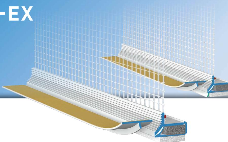
Die **APU-Gewebeleiste PUR-EX** wird in Wärmedämm-Verbundsystemen gemäss den aktuellen APU-Auswahlkriterien eingesetzt. Das Profil wird in der Laibung fluchtgerecht auf das vorhandene Bauteil geklebt und bildet somit einen sauberen und sicheren Putzanschluss.
