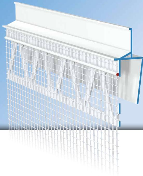
Das **APU-Fugenprofil VHF-PRO-TEX** wird bei vorgehängten, hinterlüfteten Fassaden als Abschluss auf die Kante der Trägerplatte eingesetzt. In Verbindung mit dem Fugenprofil VHF-DROP-TEX (V82) wird somit die Feldbegrenzungsfuge horizontal und vertikal ausgebildet und es entsteht eine saubere Putzkante mit Schattenfuge.
