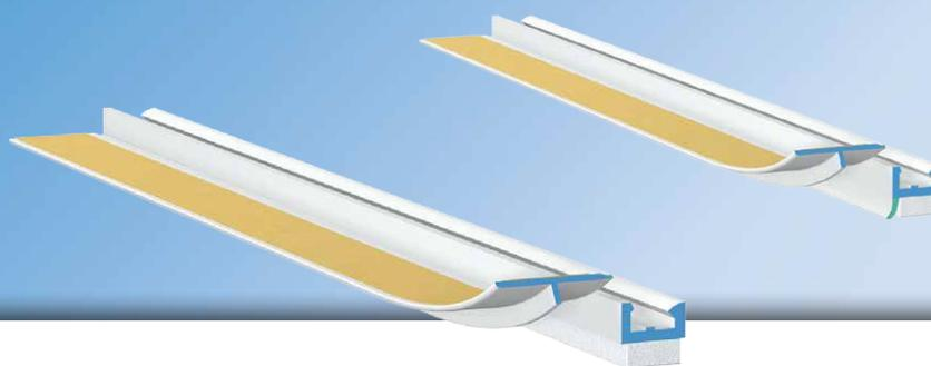
Die **APU-Anputzleiste MINI** wird bei Putzsystemen im Innen- und Aussenbereich gemäss den aktuellen APU-Auswahlkriterien eingesetzt. Das Profil wird in der Laibung fluchtgerecht auf das vorhandene Bauteil geklebt und bildet somit einen sicheren und sauberen Putzabschluss.
