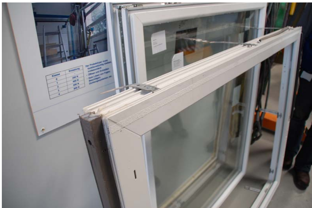
Bild 8 Gute Haftung des Schaumklebebandes zum Blendrahmen (durchweg Schaumbruch).
