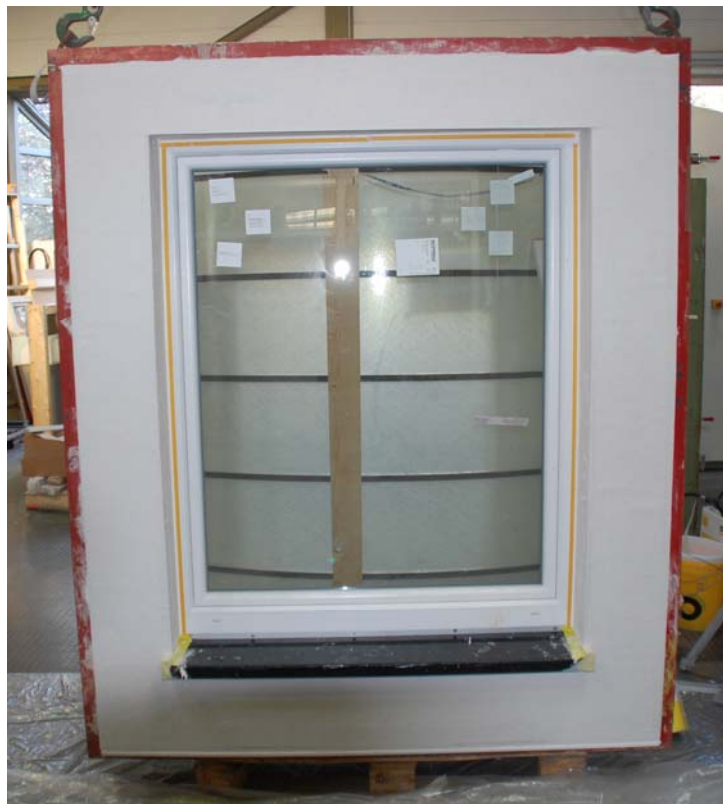
Bild 4 Probekörper mit ausgeführtem Armierungsputz.
