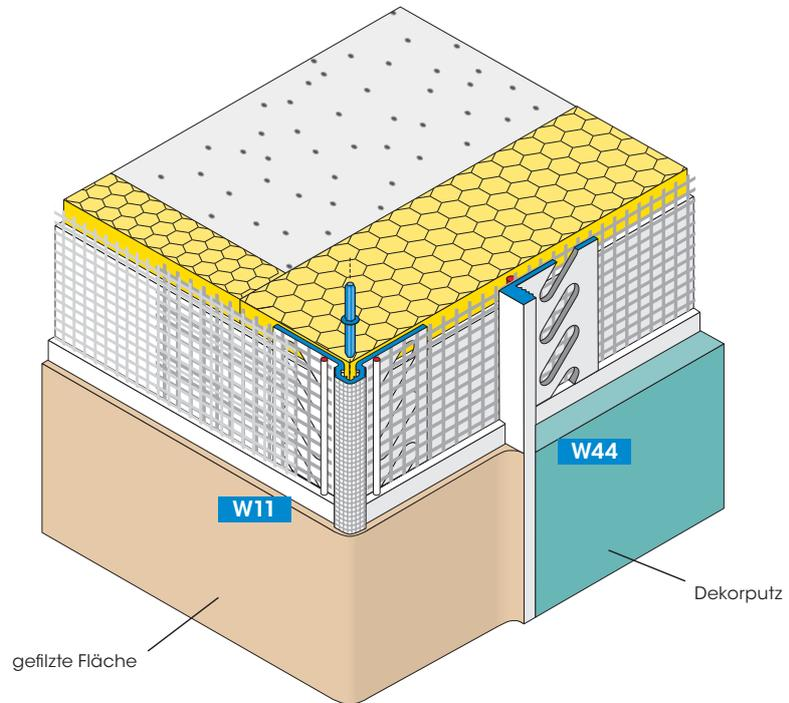
Das Abschlussprofil mit aufgeschweisstem Gewebeteil bildet Putzabschlüsse von Deckputzen auf Wärmedämm-Verbundsystemen.
