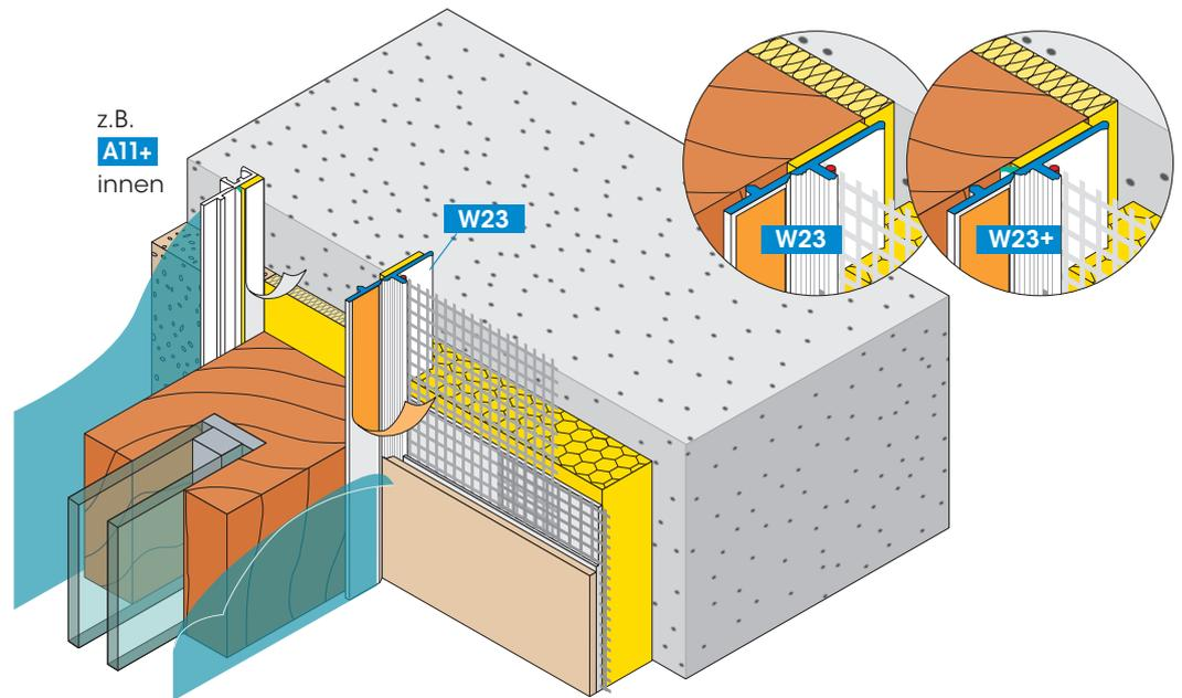
Aussenwände mit Wärmedämm-Verbundsystemen verlangen innen und aussen dichte und sichere Putzanschlüsse an Türen, Fenstern und anderen Bauteilen.
