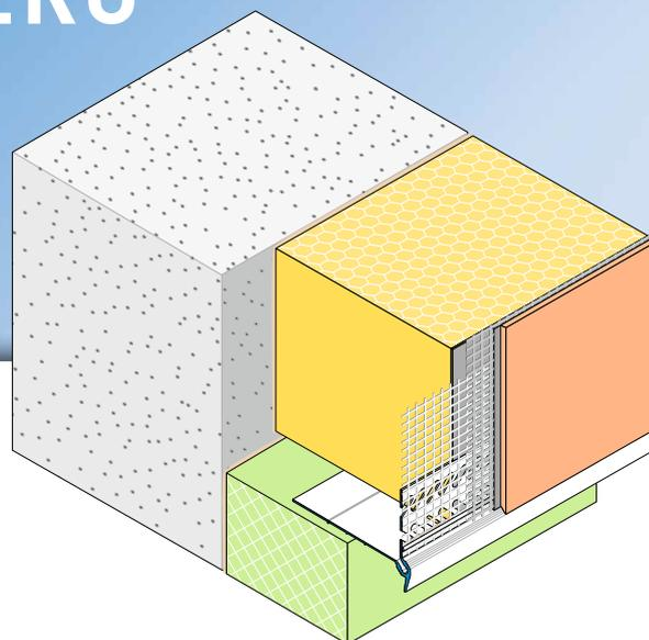
Il profilo di innesto per lo zoccolo **APU-Sockelkantenprofil SOKA-TEX-ZERO** può essere utilizzato nei sistemi di isolamento a cappotto come chiusura inferiore dell'isolamento.
