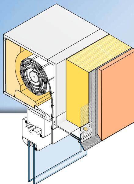
Il profilo di innesto **APU-Aufsteckprofil QUATTRO** viene inserito orizzontalmente nei sistemi di isolamento a capotto, ad esempio nei raccordi dell'intonaco alle scatole degli avvolgibili.
