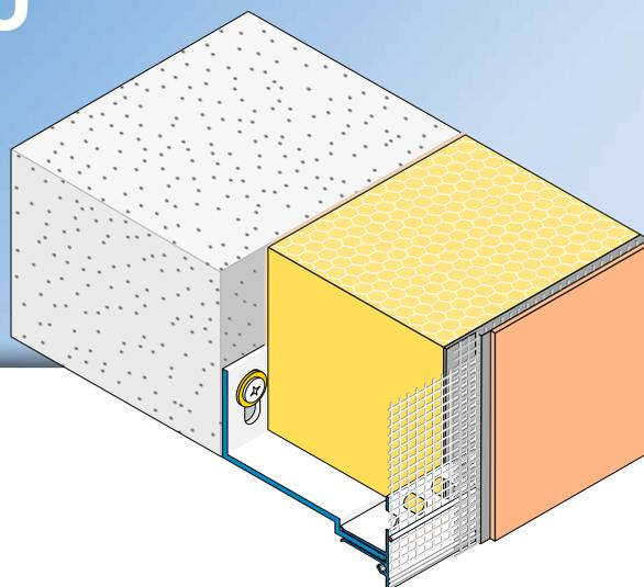
La guida per lo zoccolo **APU-Sockelschiene SOLI-TEX-UNO** può essere utilizzata nei sistemi di isolamento a cappotto come chiusura inferiore dell'isolamento.
