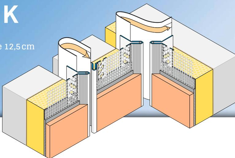
Il profilo per giunti di dilatazione **APU-Dehnfugenprofil DUO-TEX-K** si utilizza nei giunti dei sistemi di isolamento a cappotto.
