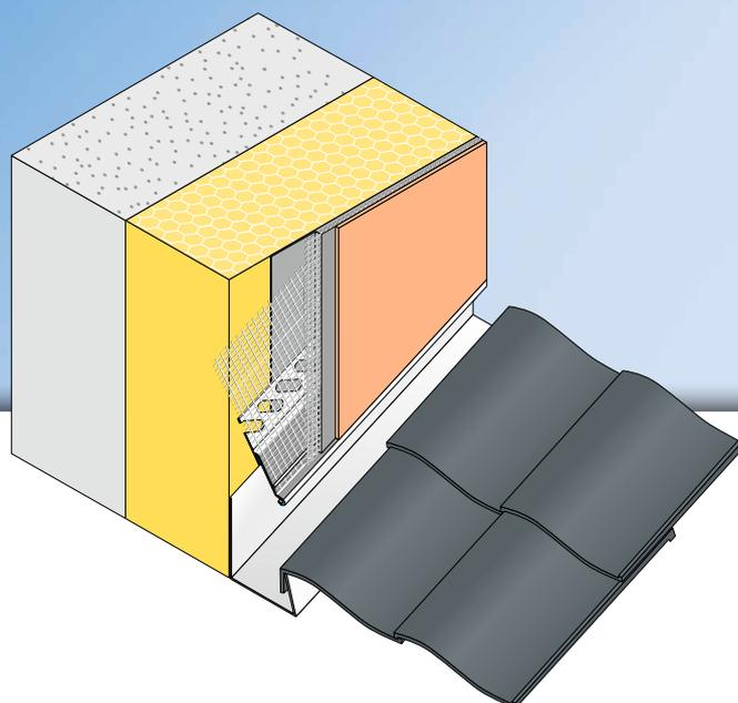
Il profilo di raccordo alla lamiera **APU-Blechan-schlussprofil FIN-TEX** si installa sui raccordi alla lamiera (ad esempio lungo la scossalina) nei sistemi di isolamento a cappotto e consente di realizzare un collegamento mobile tra intonaco e lamiera grazie alla sua camera cava. Il profilo è utilizzato per uno spessore di intonaco di 11 mm e garantisce una eliminazione mirata dell'acqua una volta completata l'intonacatura.
