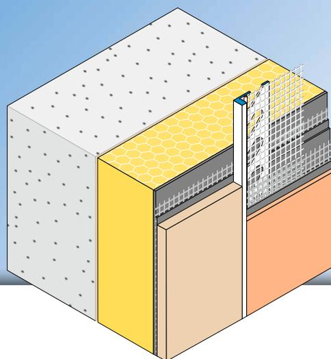
Il profilo di chiusura **APU-Abschlussprofil DECO-TEX** viene installato in sistemi di isolamento a cappotto come elemento di chiusura dell'intonaco o di separazione degli intonaci di finitura.
