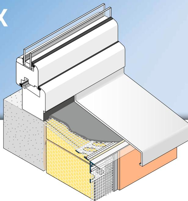
Il profilo di chiusura **APU-Abschlussprofil FEBA-DUO-TEX** è impiegato nei sistemi di isolamento a cappotto. Permette di realizzare un perfetto raccordo all'intonaco sotto il davanzale della finestra durante la realizzazione di un secondo livello isolante.
