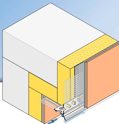
Il profilo di chiusura **APU-Abschlussprofil DROP-TEX-TRE** viene inserito orizzontalmente nei sistemi di isolamento a capotto in corrispondenza di elementi incassati, ad esempio le imbotti di porte e finestre. Il bordo inclinato del profilo con bordo di gocciolamento trasparente rappresenta una soluzione sicura per convogliare l'acqua verso il basso.
