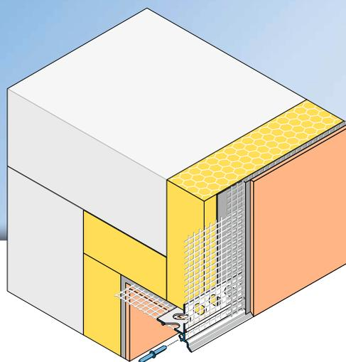
Il profilo di chiusura **APU-Abschlussprofil DROP-TEX-DUE** viene inserito orizzontalmente nei sistemi di isolamento a capotto in corrispondenza di elementi incassati, ad esempio le imbotti di porte e finestre. Il bordo inclinato del profilo rappresenta una soluzione sicura per convogliare l'acqua verso il basso.
