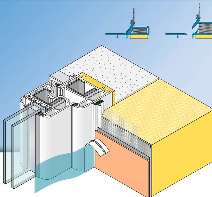
Il profilo con rete **APU-Gewebeleiste PUR-EX** è utilizzato nei sistemi di isolamento termico a cappotto secondo le indicazioni di applicazione APU. Il profilo viene incollato nell'imbotte a filo con l'elemento architettonico di riferimento in modo da realizzare un raccordo netto e sicuro all'intonaco.
