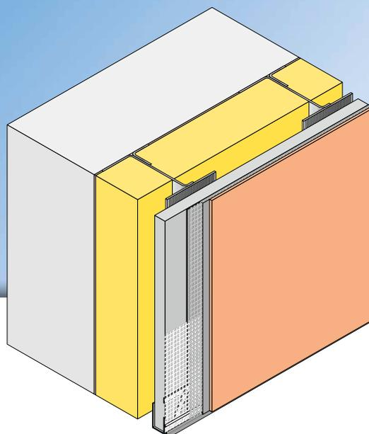
Il profilo di innesto **APU-Aufsteckprofil VHF-FIN-TEX** è utilizzato come raccordo al bordo delle lastre portanti nelle facciate di rivestimento retroventilate.
